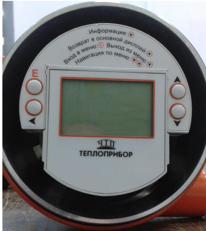
Рисунок 5 - Блок электроники с установленным дисплеем.
