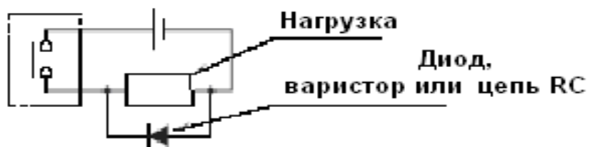
Рисунок Е.3 – Схемы защиты контактов реле сигнализации при индуктивной нагрузке
