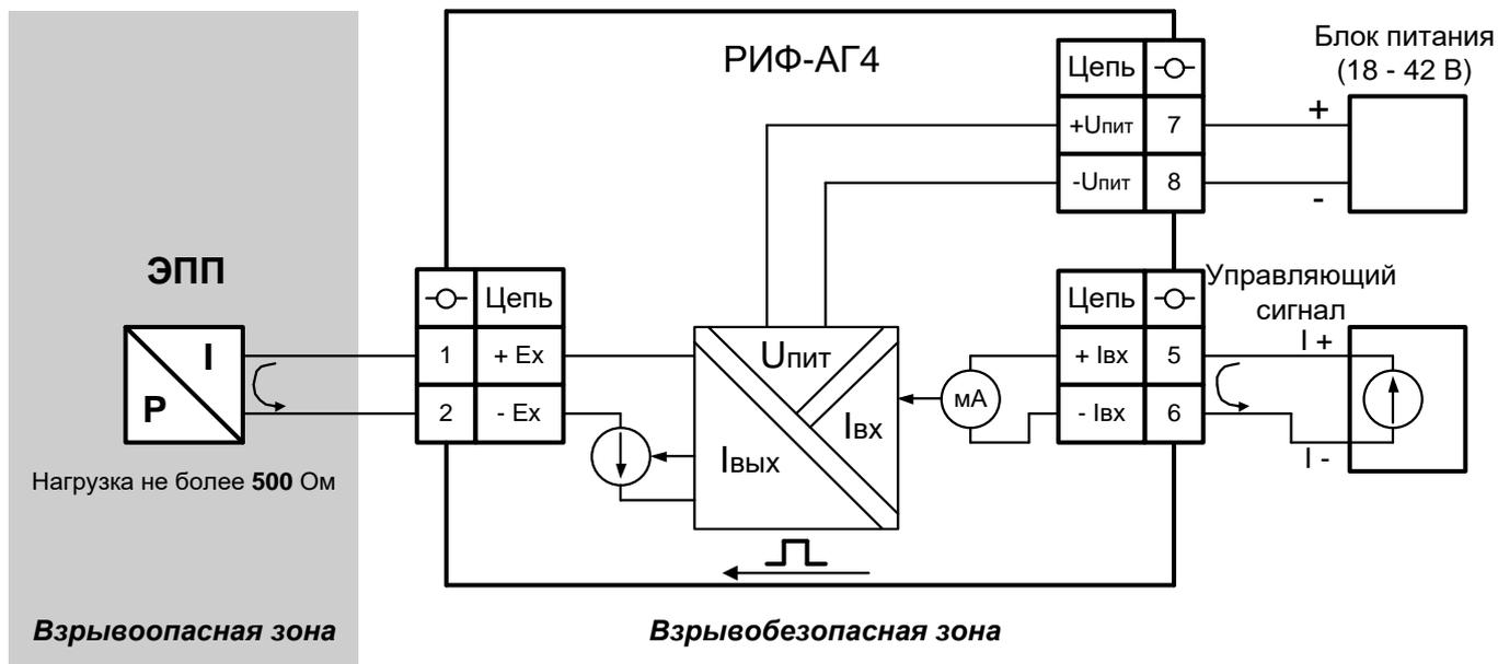
ЭПП – электропневмопреобразователь
