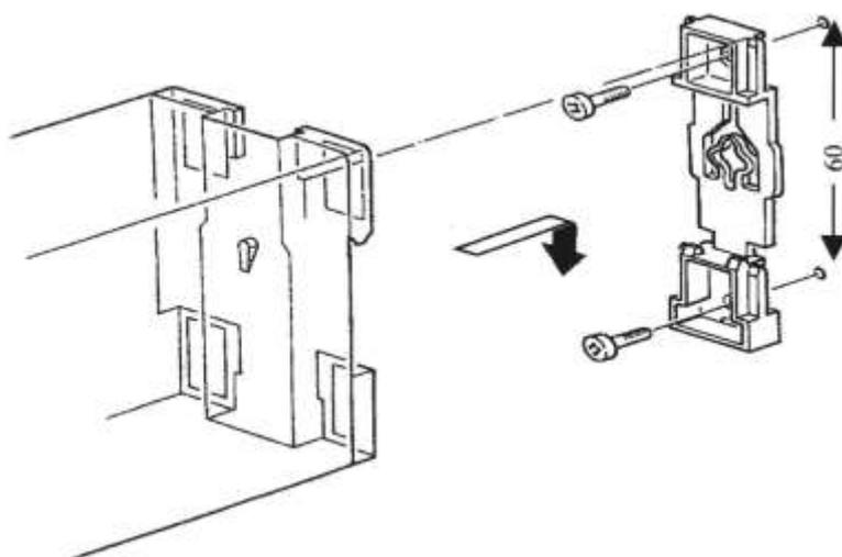
Рисунок Б.3 – Монтаж барьера на DIN-рейку
