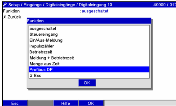
Abb. 7: Digitalkanal auf Profibus-DP stellen
