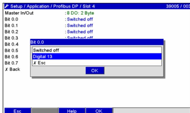
Рисунок 17: Выбор цифрового канала, Profibus master → устройство
